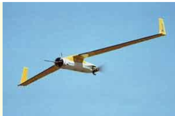
ScanEagle er Boeings langdistance UAV. Dronen sendes af sted med en katapult.
